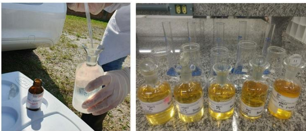
Figura 3: Análise de oxigênio dissolvido: Reagentes adicionados “in loco” no momento da coleta e análises realizadas posteriormente em laboratório.
