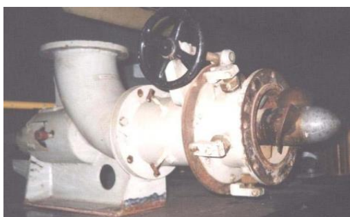
Figura 23: Modelo reduzido de turbina hélice do tipo tubular, com tubo de sucção desmontado para visualização do rotor (ALBUQUERQUE, 2006 apud LHPCH – UNIFEI)
