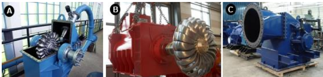
Figura 21: (a) Turbina Pelton; (b) Turbina Turgo (c) Turbina Michell-Blanki (Adaptado de Hidro GD, 2019)
