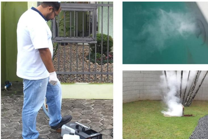
**Figura 11: Teste com injeção de fumaça.**
