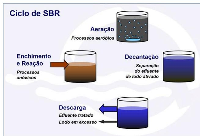
**Figura 1: Fases de um ciclo de tratamento em um reator SBR – fonte Rotária do Brasil – <http://brasil.rotaria.net/reator-sbr/>**
