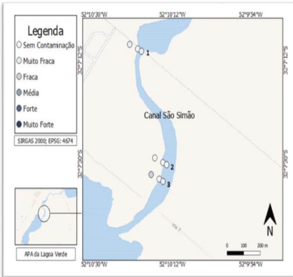
Figura 9- Canal São Simão, identificação dos locais de lançamento de efluentes e seus níveis qualitativos de contaminação.
