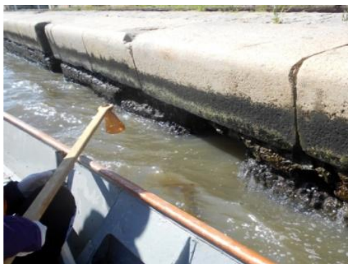
Figura 1- Amostrador introduzido no interior da estrutura por onde desemboca o efluente na margem, para a sua coleta antes de seu deságüe e para coletas da sua água receptora. Fonte: Aguiar et al. (2014)
