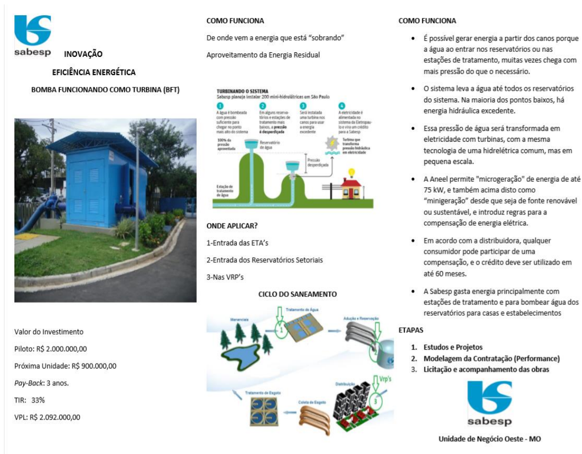
Figura 4: Ciclo do Saneamento e como funciona uma BFT (fonte: site PNQS, Abril/19).
