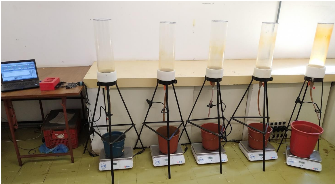
Figura 1 - Sistema de desaguamento (Leito de Drenagem) e medição de vazão utilizados nesta pesquisa.
