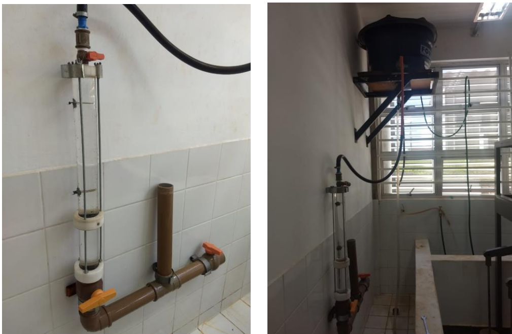
Figura 3: Equipamento utilizado no ensaio de permissividade
