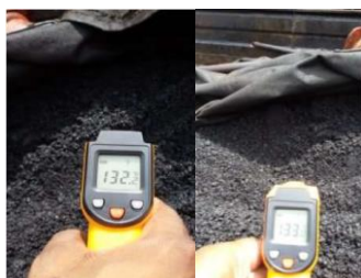
Figura 2: Aferição de temperatura asfáltica com uso do termômetro infravermelho
