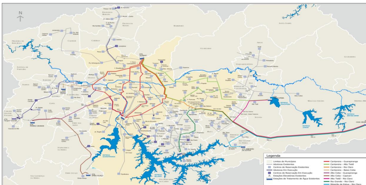
Figura 2 – Sistema Adutor Metropolitano – SAM – em destaque os principais pontos de integração entre os sistemas produtores via SAM (Sabesp, 2016)
