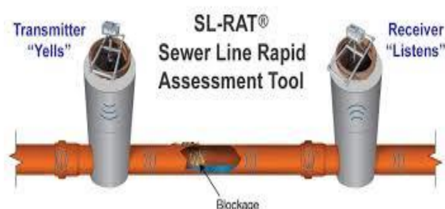
Figura 2 – Equipamento de inspeção acústica
