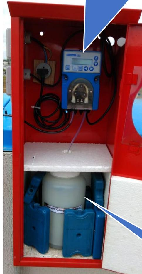
Reservatório de amostra (4L) em caixa térmica com gelo
