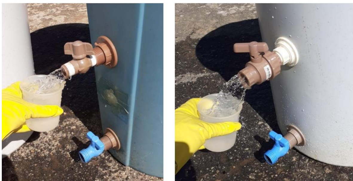
Figura 07: amostras sendo obtidas para análise dos parâmetros. Fonte: própria (2021).
