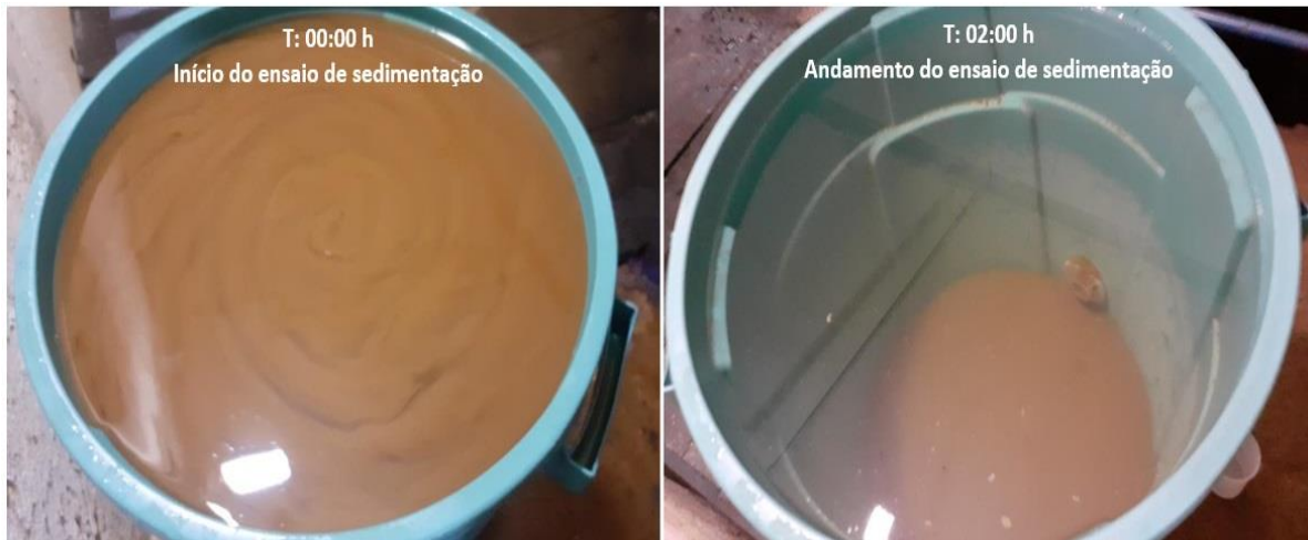
Figura 08: ensaio de sedimentação com efluente de filtro. Fonte: própria (2021).
