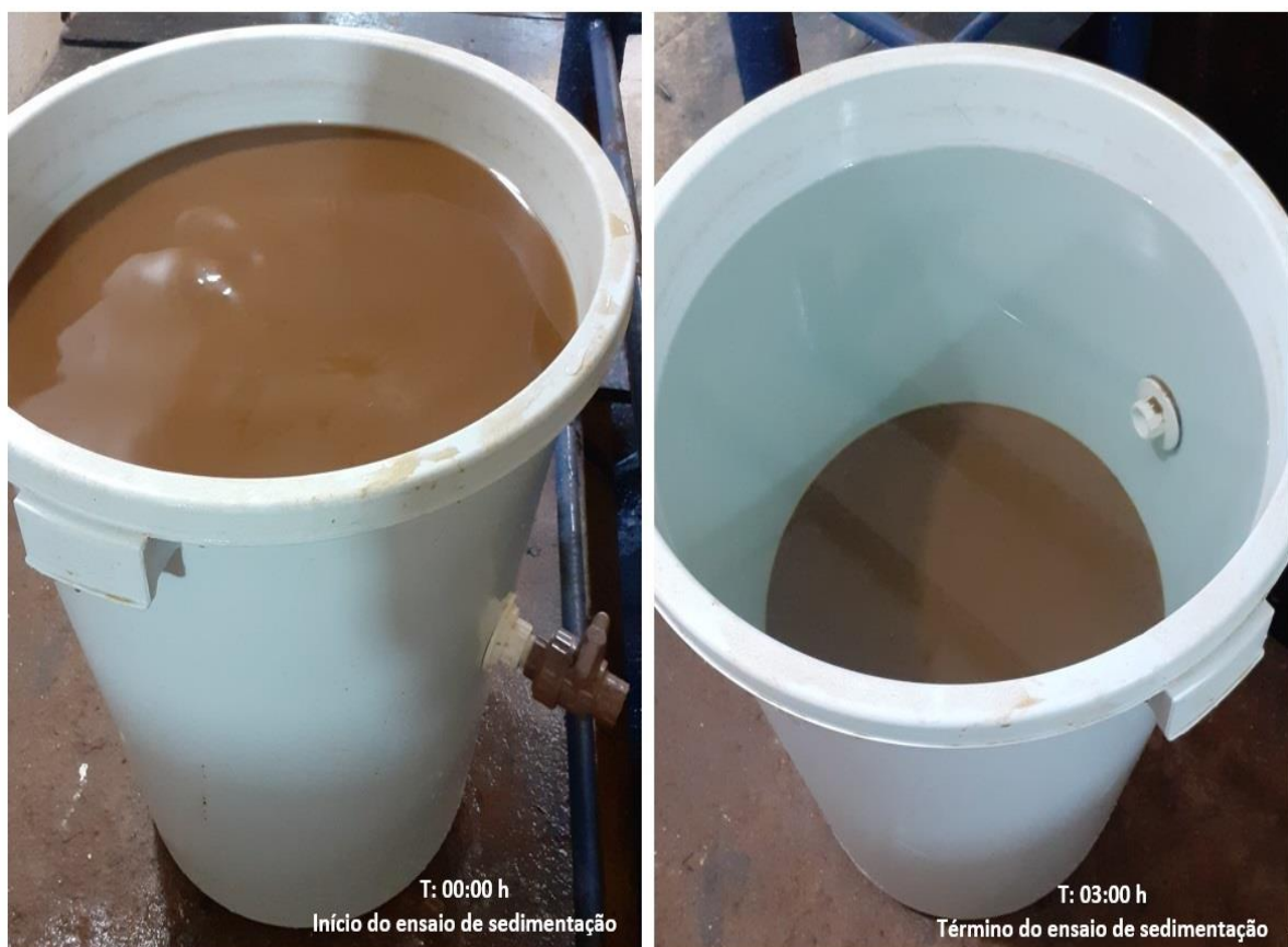
Figura 09: ensaio de sedimentação com efluente de decantador. Fonte: própria (2021).
