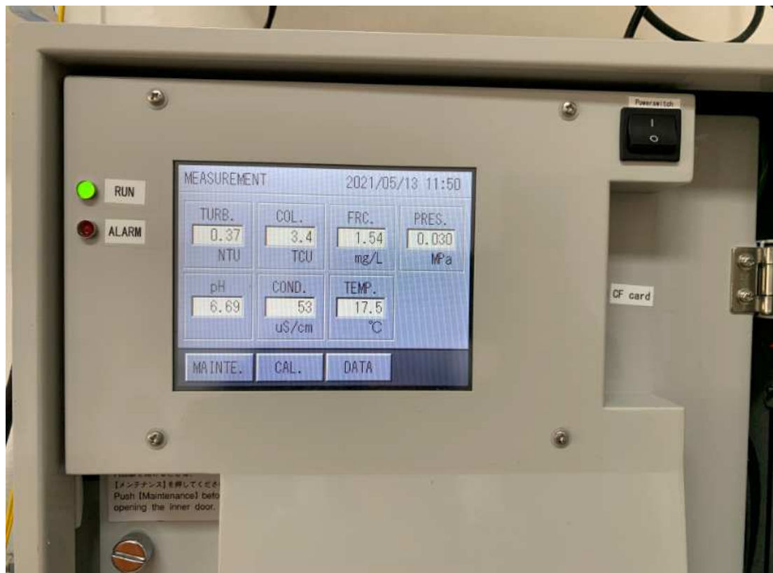
Figura 10 – Resultado físico-químico (pH, cor aparente, turbidez, cloro residual livre e condutividade) on line visualizado no equipamento
