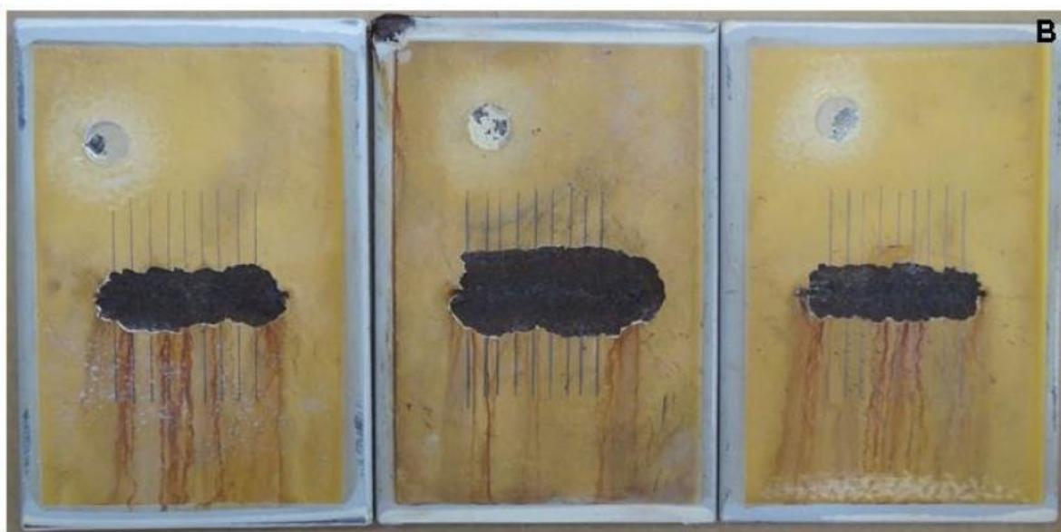
**Figura 2: Aspecto dos corpos de prova do fornecedor B após o ensaio cíclico na condição C5 High da ISO 12944-6. Fonte: IPT, 2020.**
