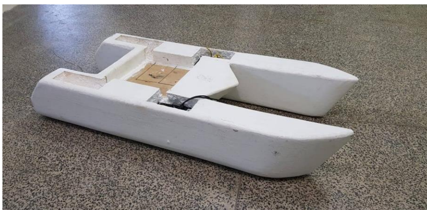
Figura 2: Protótipo em isopor, revestido com resina epóxi reforçada com fibra de vidro. Fonte: Elaborada pelo autor, 2020.
