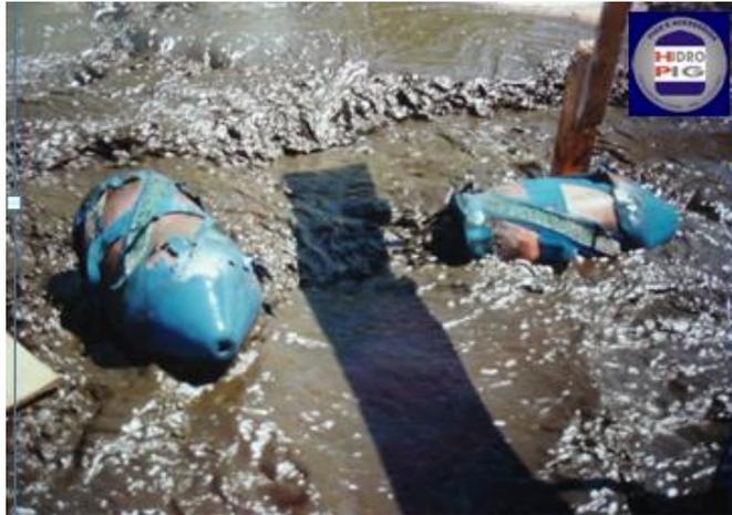
Foto 01 – Exemplo de Pig, após a sua passagem em tubulações (Fonte: Hidropig)
