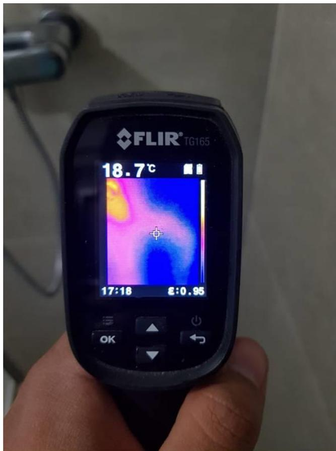
**Figura 04 – Localização de Térmica de Vazamentos.**
