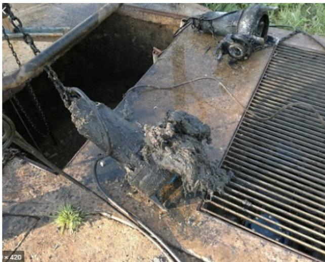
**Figura 1: Resíduos concentrados no equipamento de bombeamento**
