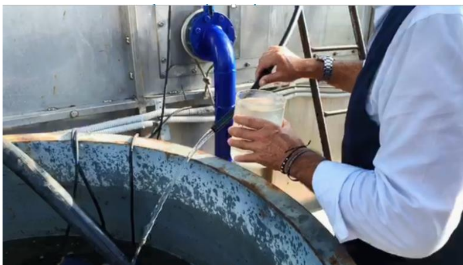
Figura 7: Coleta de amostras para caracterização do efluente tratado.
