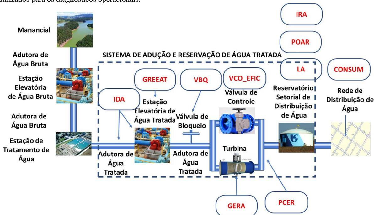
**Figura 5: Esquema de um sistema público de abastecimento de água. Em vermelho, estão os nomes dos aplicativos para o diagnóstico operacional do sistema de adução e reservação de água tratada.**
