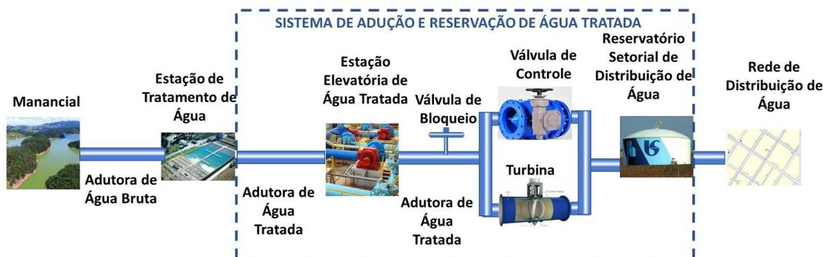
Figura 1: Esquema de um sistema público de abastecimento de água.
