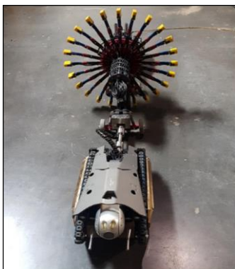
Figura 2: Veículo de inspeção Multissensor ou Robô de Inspeção Eletromagnética
