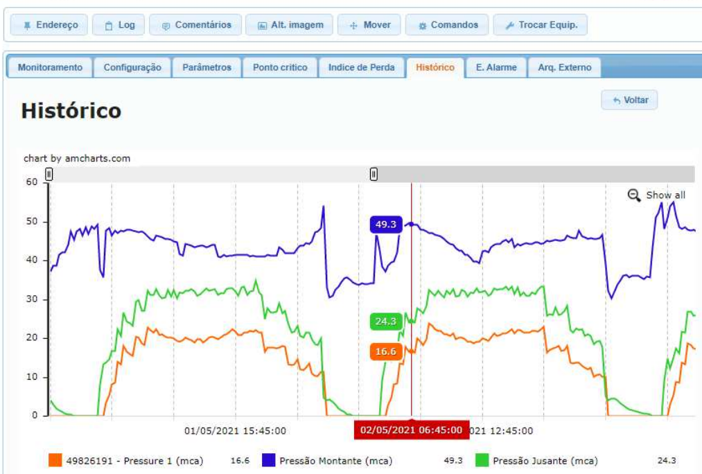
Figura 8: Curva de variação das pressões montante, jusante e Ponto Crítico da VRP.
