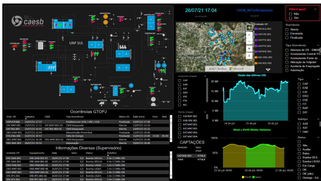
Figura 6: Painel de sistema de captação, armazenamento e distribuição de água.
