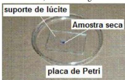
**Figura 4:** Suporte de lúcite utilizado para a deposição da amostra.
