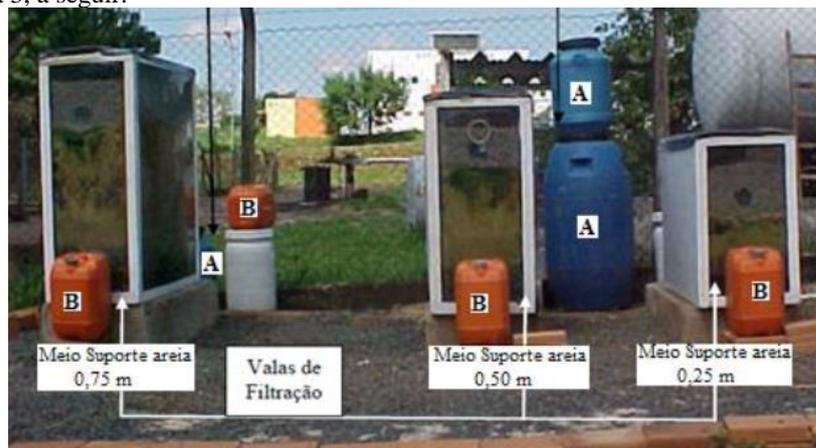
**Figura 3:** Sistema geral das valas de filtração.
