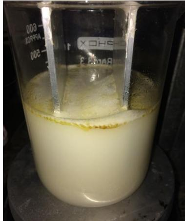
**Figura 2: Foto ilustrativa do efluente de Biodiesel submerso na célula eletrolítica antes do tratamento de eletrocoagulação/eletroflotação.**
