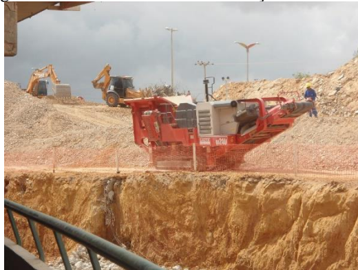
Figura 2. Britador utilizado na trituração dos resíduos.
