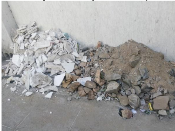
Figura 8. Resíduos de pedras, areia e gesso da construção civil.
