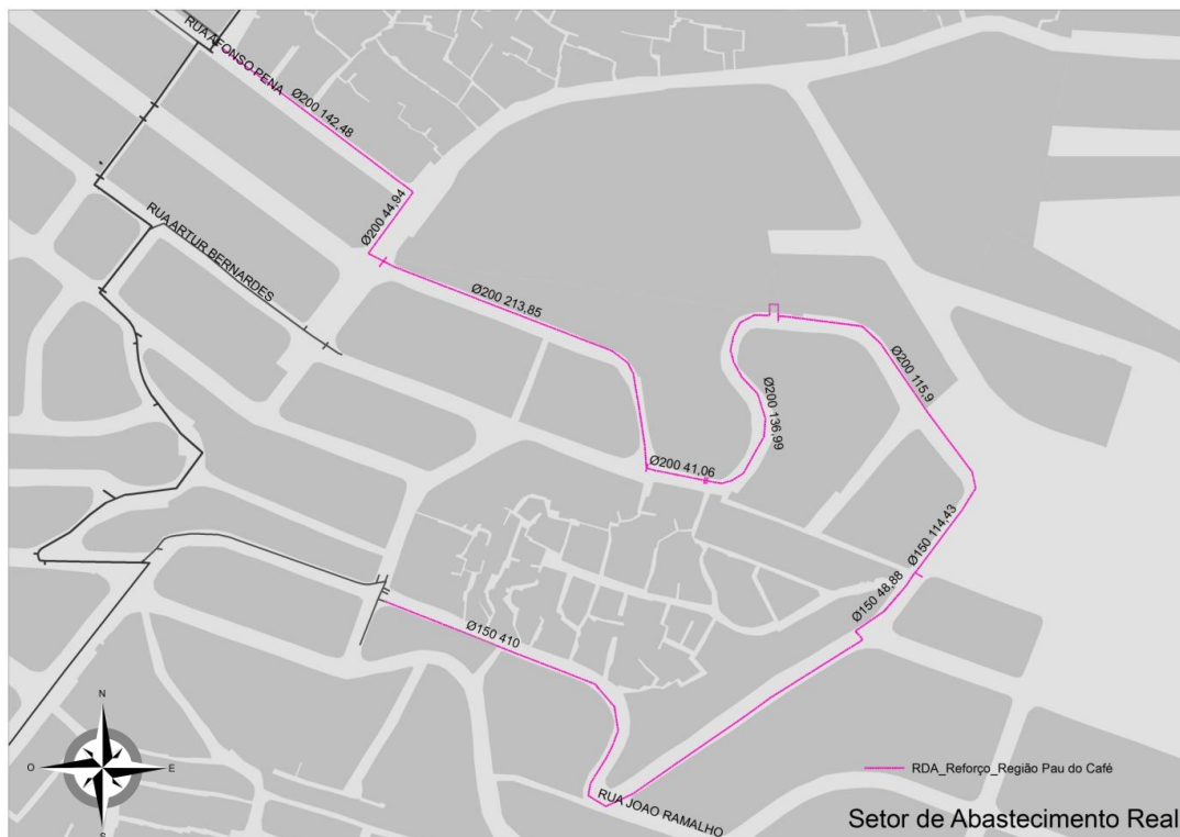
Figura 9 – Projeto para construção de um anel de DN 200 mm na região do bairro Serraria.
