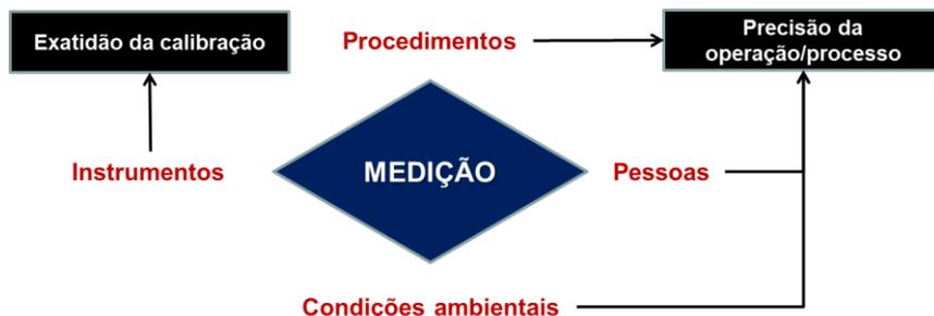
**Figura 1 – Principais variáveis do processo de medição. A exatidão da calibração representa as incertezas herdadas (tipo b) e a precisão da operação as incertezas experimentais (tipo a).**
