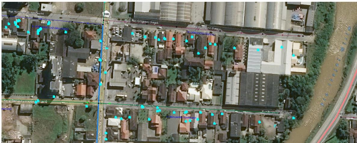
**Figura 2: Ligações de água com o consumo micromedido após o trabalho de georreferenciamento e inseridas no modelo hidráulico.**
