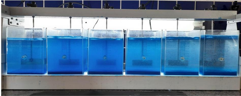
Figura 18: Água sintética em fase final de decantação (tempo 00:30:00 h) após o ensaio Jar Test.
