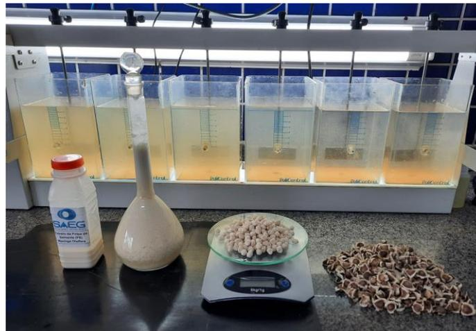
**Figura 4: semente de Moringa oleífera utilizada nos ensaios como coagulante natural.**
