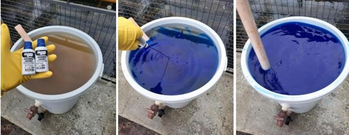
**Figura 15: Formação da água sintética “colorida” para uso no ensaio *Jar Test*.**
