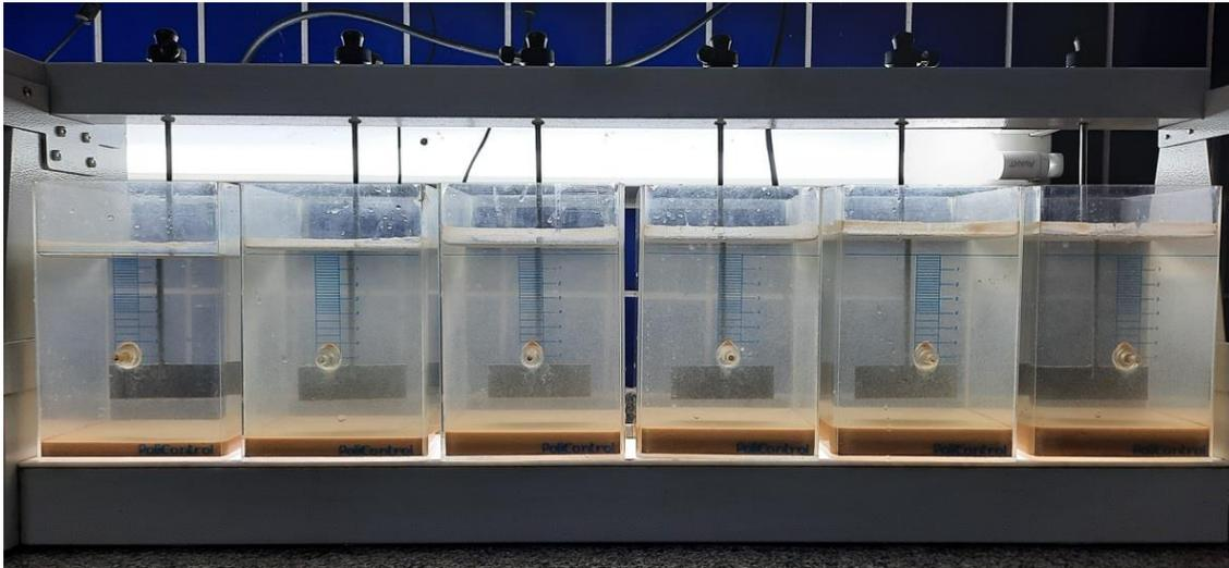
**Figura 23: Tempo de decantação de 00:30 h finalizado no ensaio *Jar Test*.**
