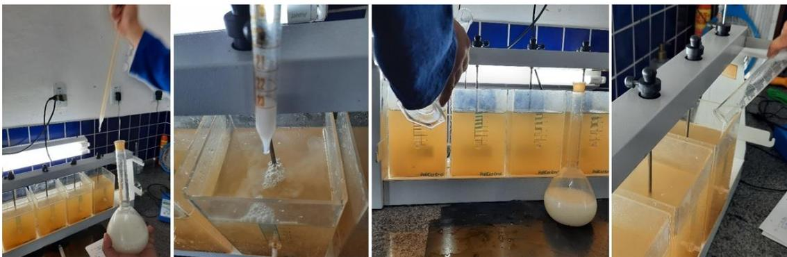
**Figura 7: Dosagem do extrato coagulante a base de Moringa oleífera no teste de jarra.**
