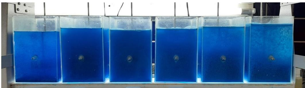
**Figura 17: Água sintética em fase inicial de decantação (tempo 00:00:00 h) após o ensaio *Jar Test*.**
