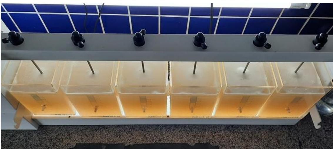
**Figura 8: ensaio *Jar Test* realizado com uso do extrato da semente da Moringa.**
