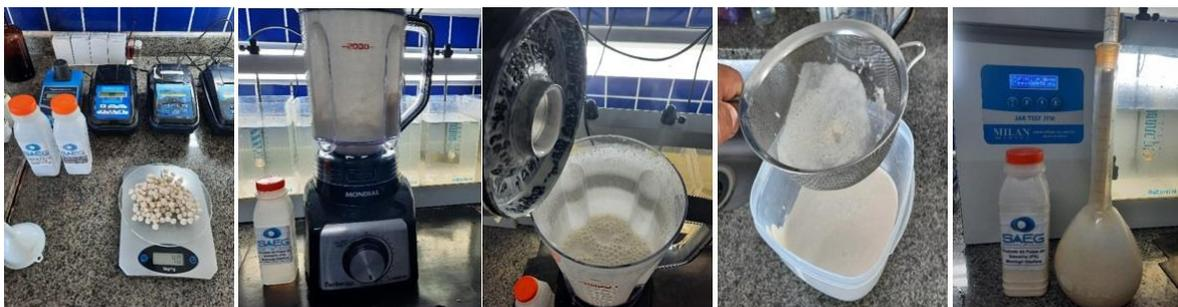
**Figura 5: Uso da polpa da semente de Moringa (PS) para a obtenção do extrato coagulante.**
