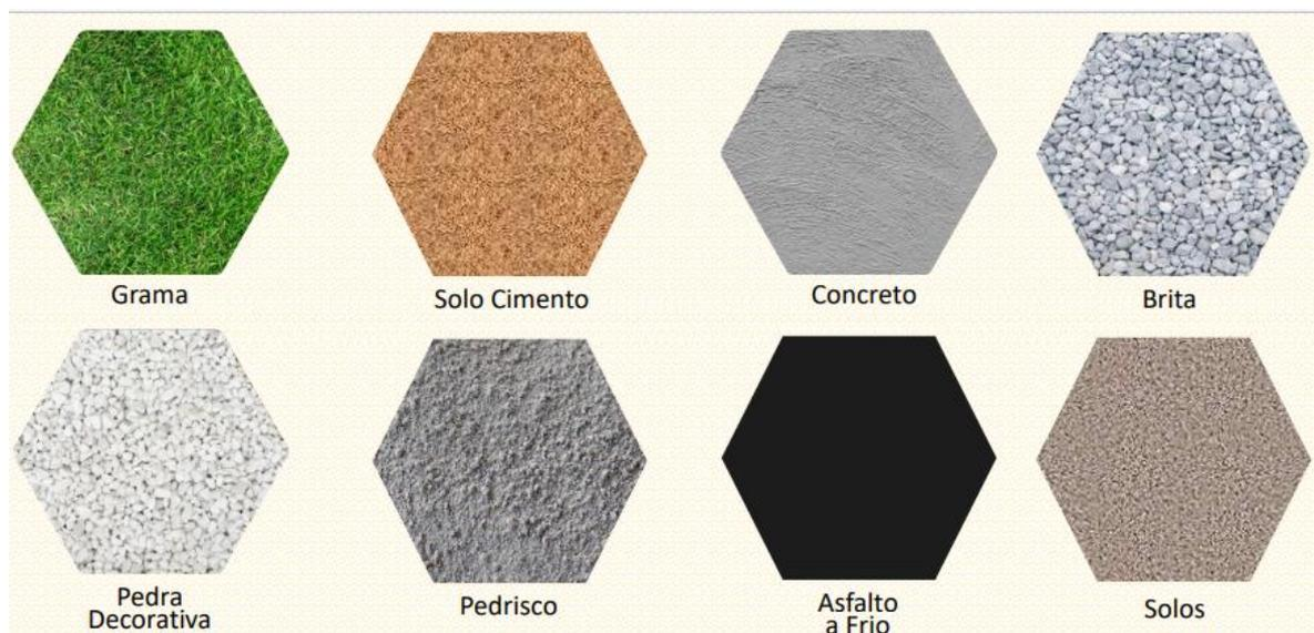
**Figura 3: Exemplos de materiais para preenchimento da Geogrelha**
