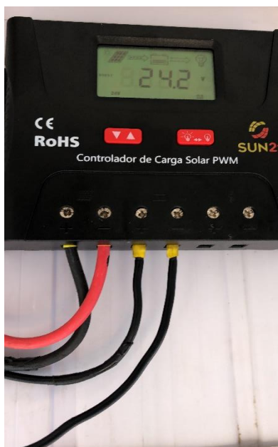
Figura 5 - Controlador de carga
