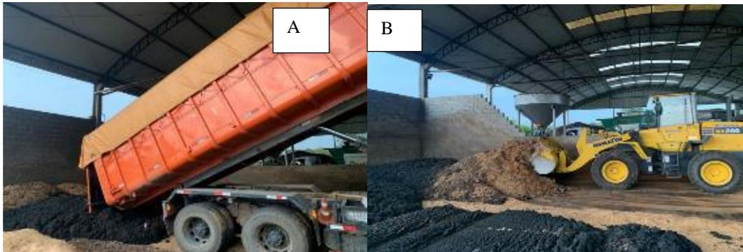
**Figura 04: a) recebimento do lodo desidratado b) adição de material estruturante**
