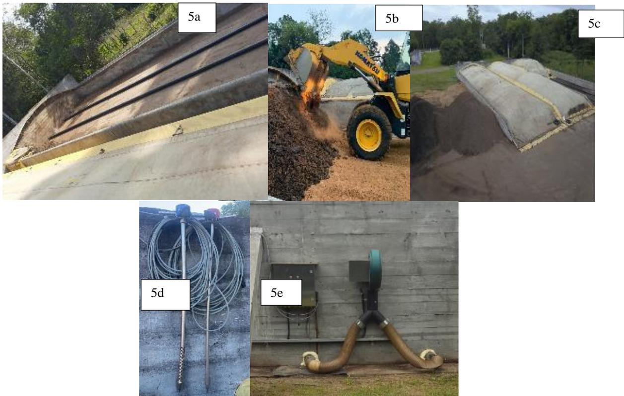
**Figura 5: a) leira vazia b) lodo com material estruturante sendo colocado na leira c) leira já fechada e coberta com as membranas semipermeáveis, d) sensores de temperatura e oxigênio e) sistema de aeração.**
