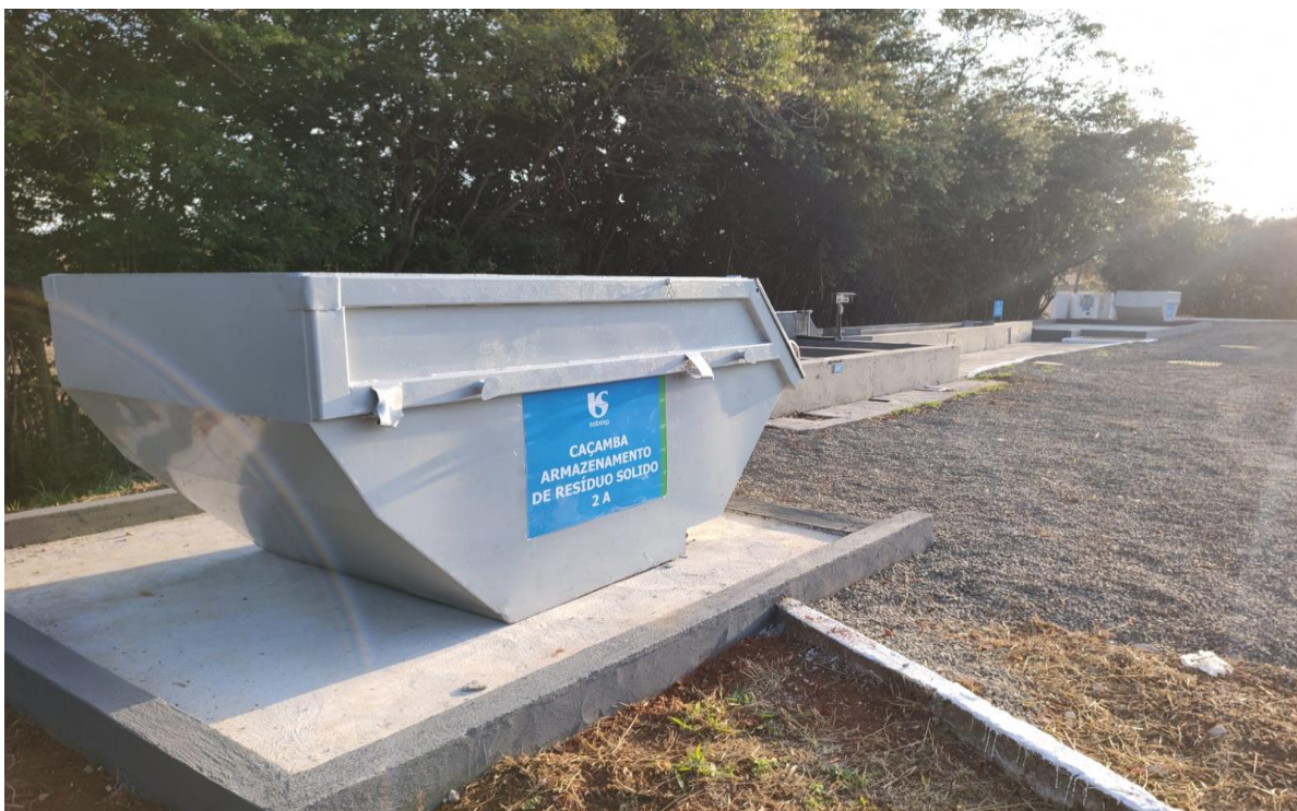
Figura 4: Caçamba para resíduos sólidos classe IIA.
