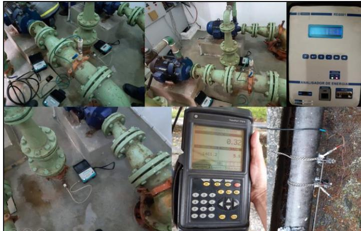
**Figura 10 – Registrador de pressão, vazão e grandezas elétricas.**
