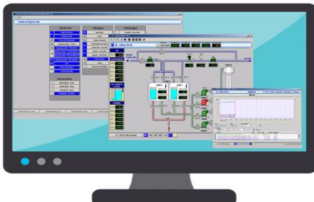
Figura 1: Exemplo da utilização do sistema do tipo SCADA para monitorar uma EEAT. Fonte: Autor
