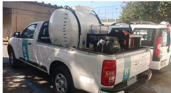
**Figura 1b - Equipamentos Mini adaptado à caçamba de veículo utilitário.**
