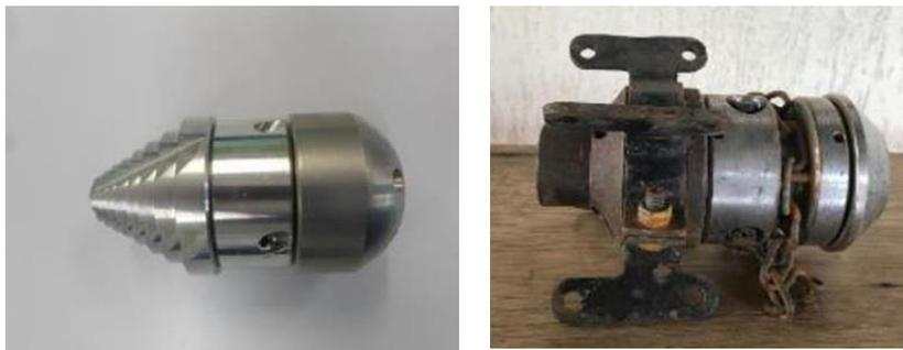
**Figura 4: Exemplos de modelos de bocais para a remoção de obstruções rígidas.**
