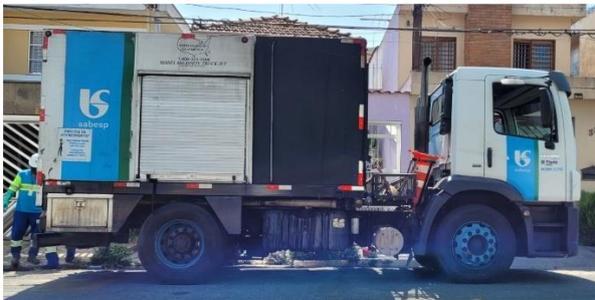
**Figura 1a - Equipamentos Sewer jet em chassi de caminhão.**
