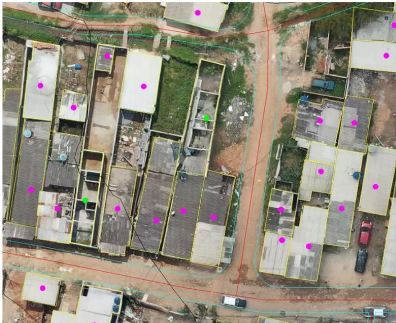
**Figura 6: Restituição de vias com eixo e edificações (consolidadas x construção). Fonte: Sabesp (2022)**
