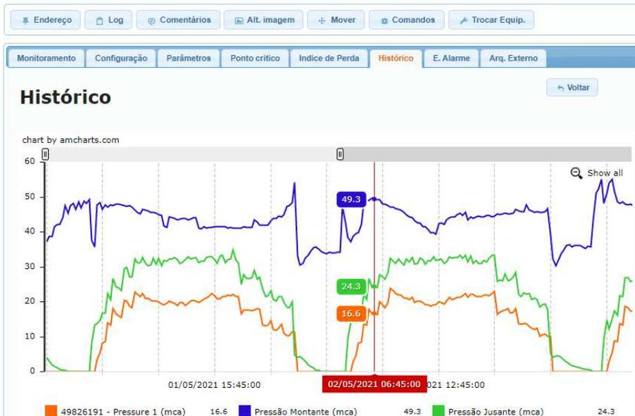
**Figura 7: Curva de variação das pressões montante, jusante e Ponto Crítico da VRP.**
