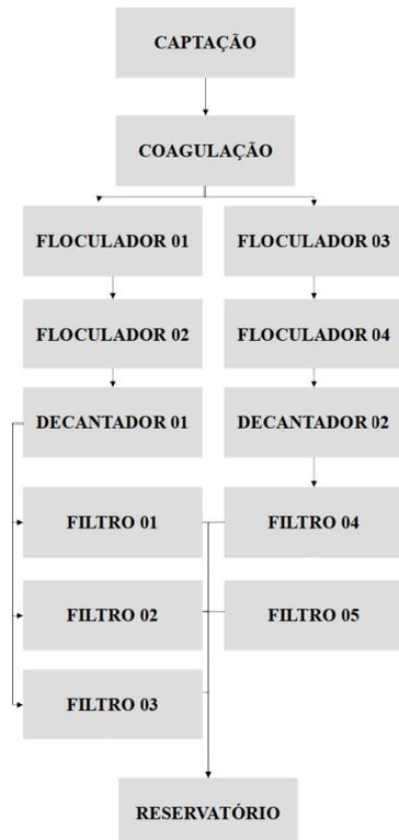
**Figura 2: Fluxograma do processo de tratamento da ETA Quitaiús**
