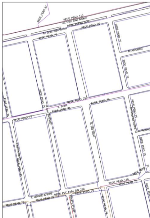
Figura 4 – Sistema das novas redes com uma válvula de bloqueio por quarteirão. (Fonte: Semae).
