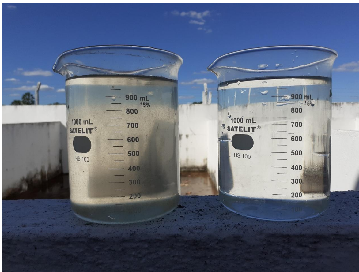
Figura 7 — Amostra comparativa entre água bruta (à esquerda) e água recirculada (à direita).
