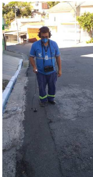
(b) Pesquisa de vazamento - Geofone eletrônico
