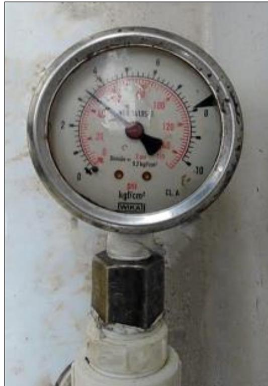
**Figura 4: Medição de pressão no ponto de injetamento.**
