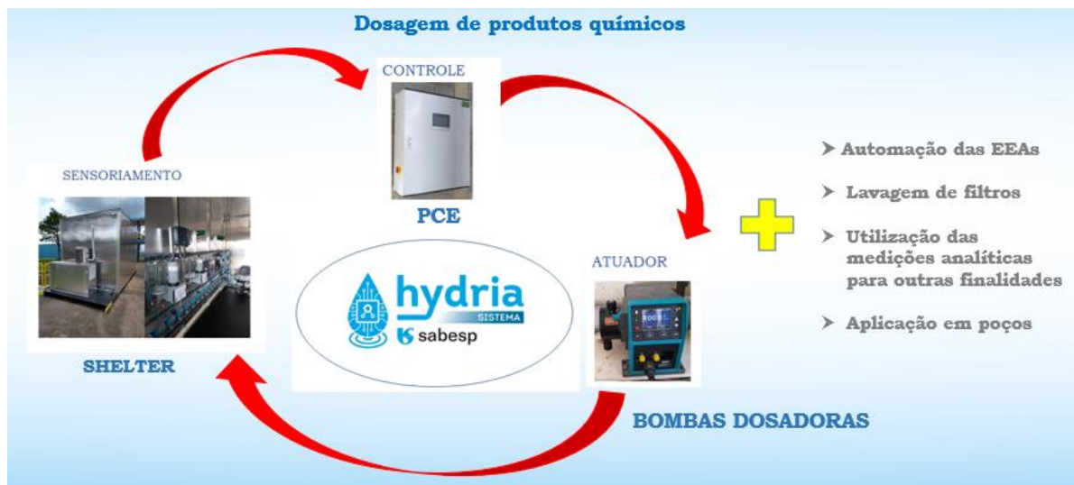
Figura 1. Esquema básico de funcionamento do Sistema Hydria na automação em ETAs.
