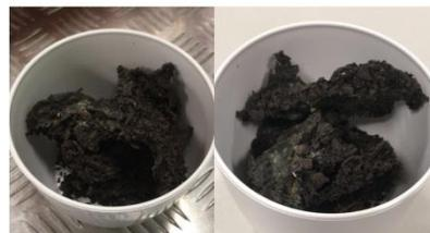
Procedimento: Análise através de ensaios com concreto moldado utilizando o lodo como substituto parcial de agregado miúdo em comparação com o mesmo concreto sem o acréscimo do resíduo.
