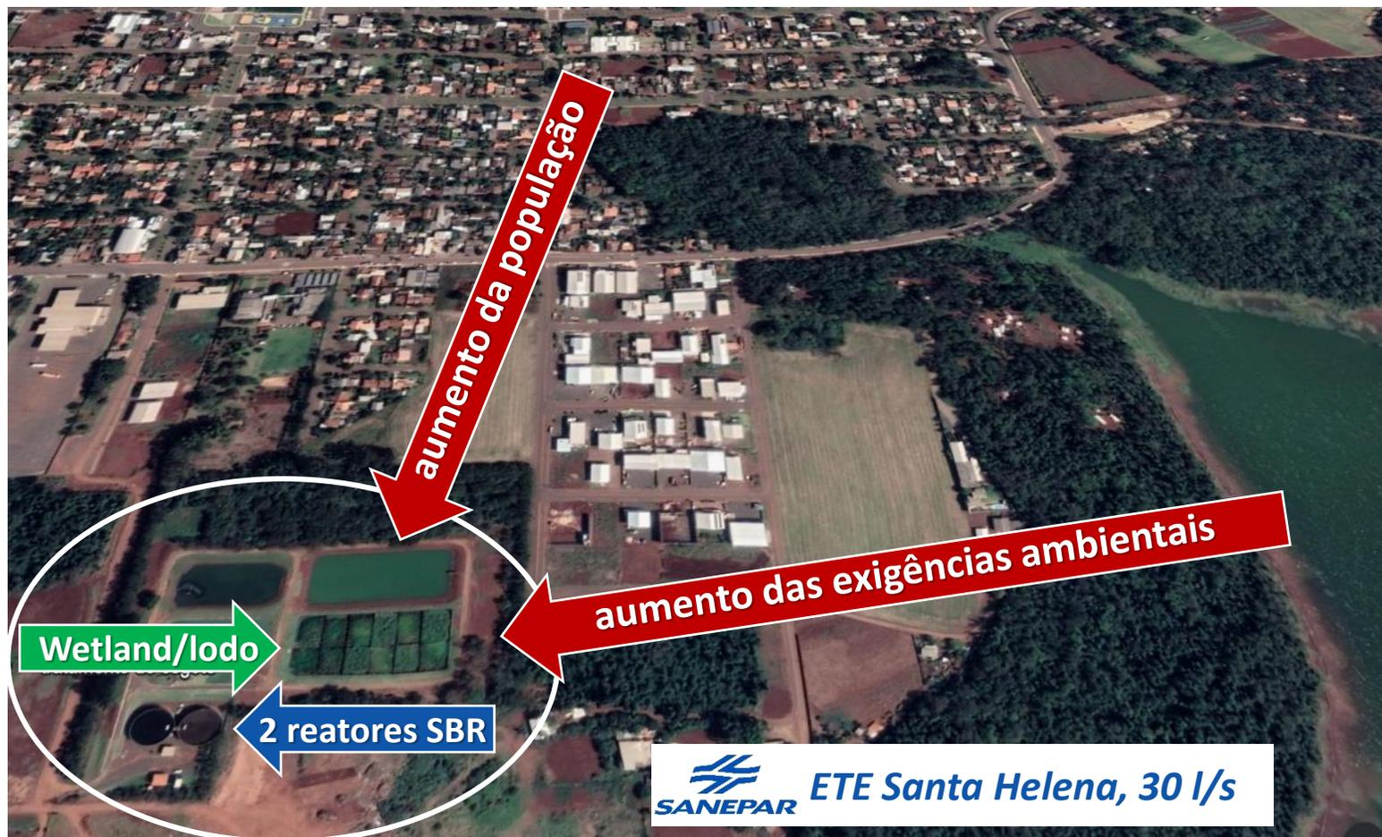
**Em 2019: Transformação da ETE existente (sistema de lagoas) para 2 reatores SBR com capacidade de tratar uma vazão de 30 L/s (e vazão de pico de 45 L/s).**
