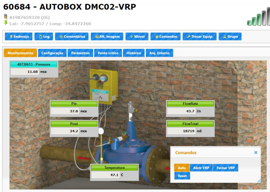
Figura 10 - Sistema Vectorasys: VRP de um dos DMCs de Olinda com seu quadro de comandos por telemetria
