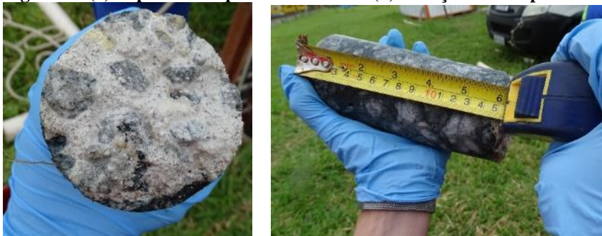
Figura 1 - (a) Aspecto do topo do testemunho (b) medição do comprimento
