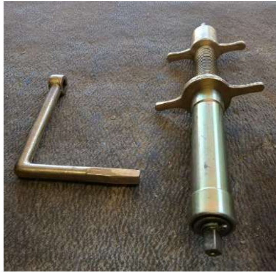
Figura 7 - Ferramenta utilizada para perfuração da rede durante os testes.
