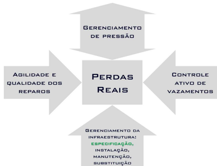
Figura 1 – Cruz de Lambert com as quatro principais abordagens para redução de perdas reais. Fonte: adaptado de Lambert & Fantozzi (2005).
